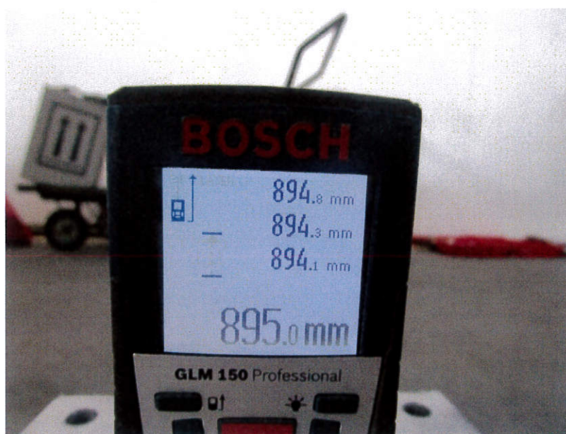
圖 1.8 風管段 4 法蘭接駁位之變形量測試
