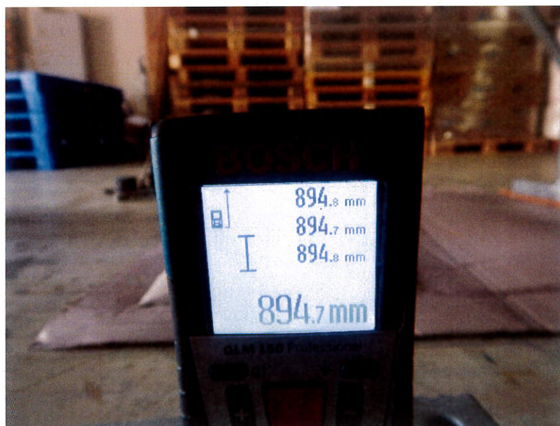
圖 1.10 風管段 5 法蘭接駁位之變形量測試
