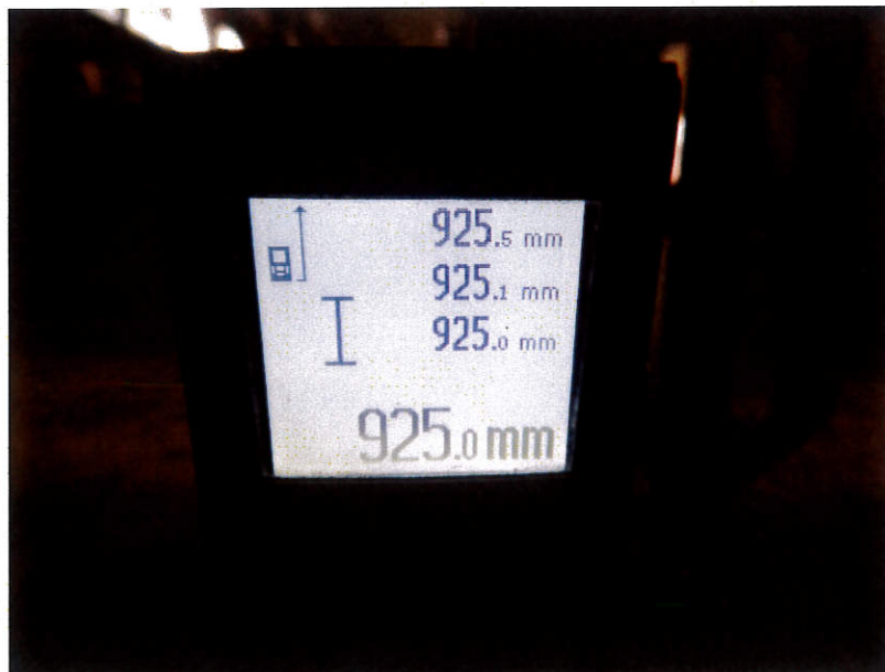
圖 1.2 風管段 1 法蘭接駁位之變形量測試
