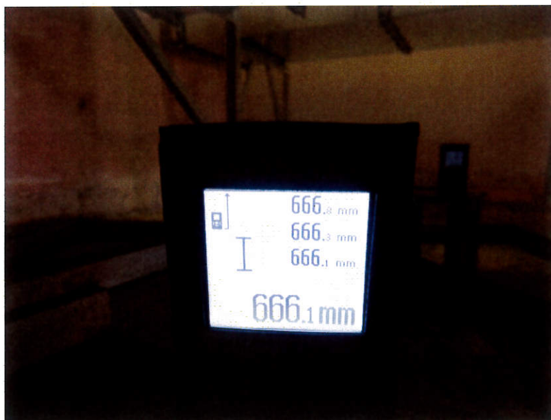
圖 1.14 風管段 7 法蘭接駁位之變形量測試
