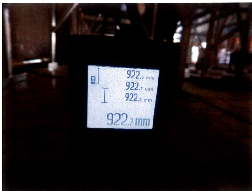
圖 1.4 風管段 2 法蘭接駁位之變形量測試
