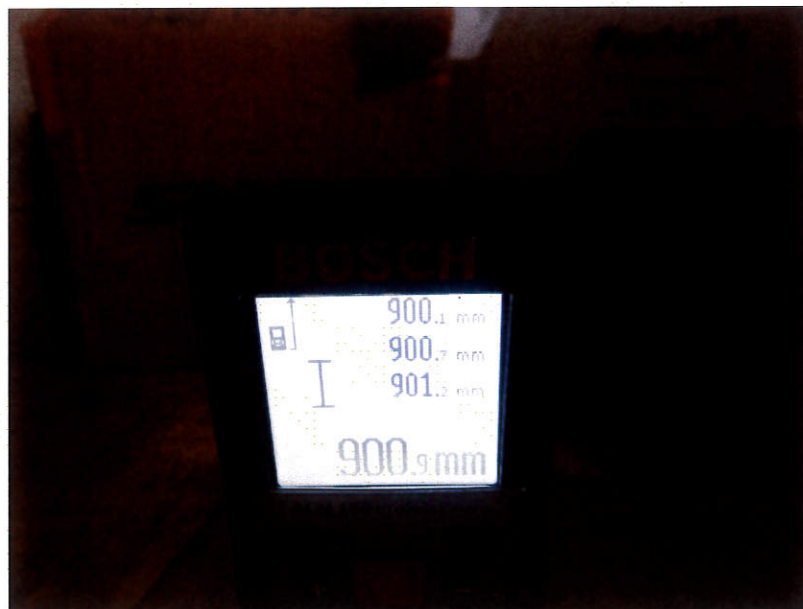
圖 1.8 風管段 4 法蘭接駁位之變形量測試
