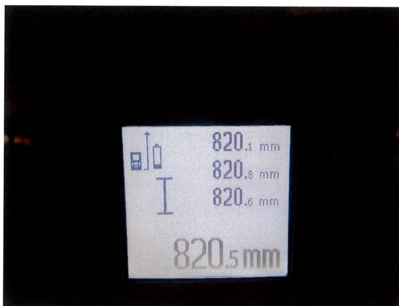
圖 1.8 風管段 4 法蘭接駁位之變形量測試
