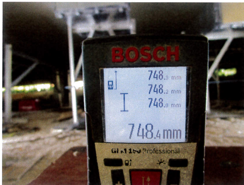
圖 1.6 風管段 3 法蘭接駁位之變形量測試
