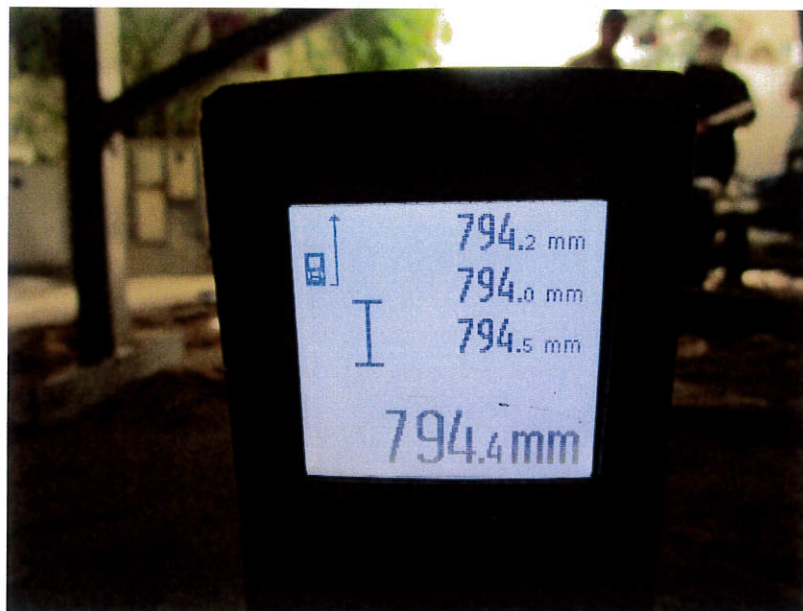
圖 1.12 風管段 6 法蘭接駁位之變形量測試
