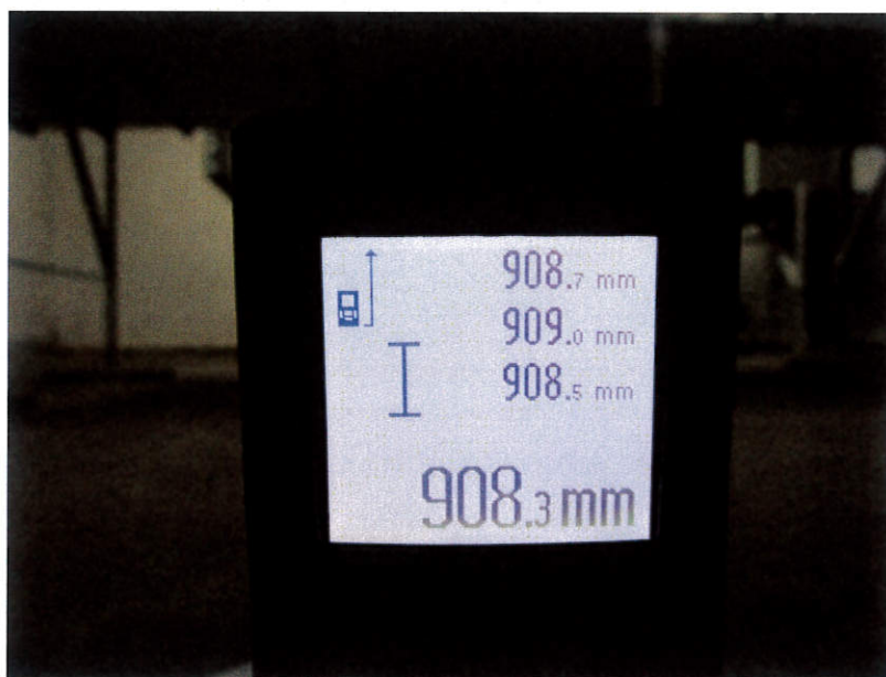
圖 1.4 風管段 2 法蘭接駁位之變形量測試
