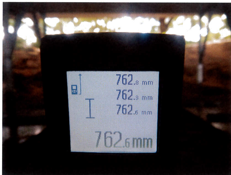
圖 1.2 風管段 1 法蘭接駁位之變形量測試
